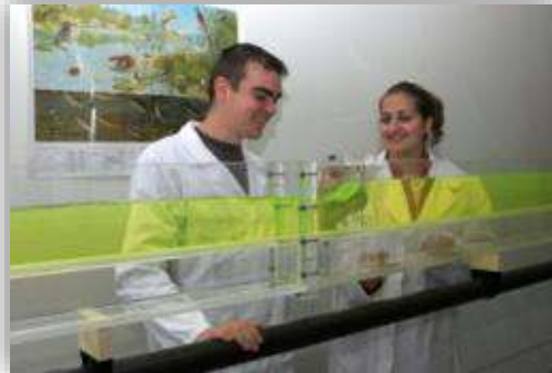
Canal d'écoulement à surface libre
