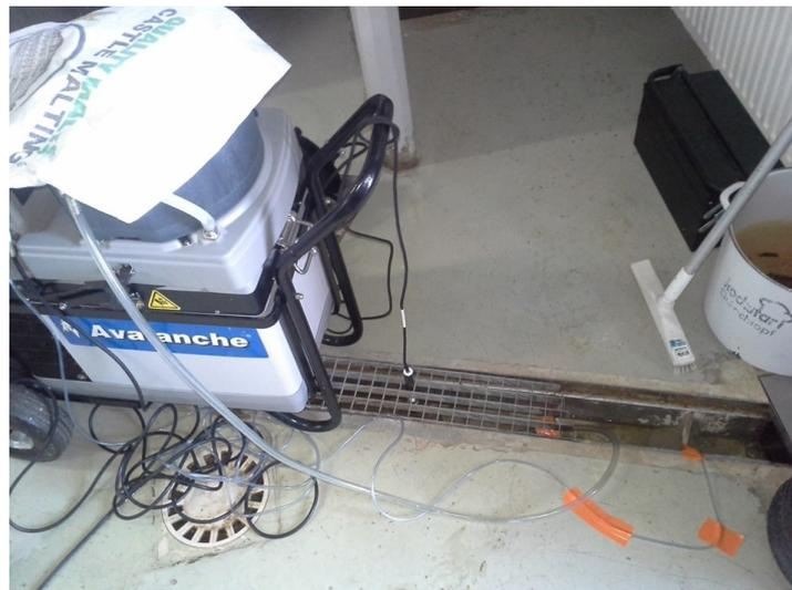
**Fig. 1 Matériel de prélèvement installé dans les brasseries volontaires**
